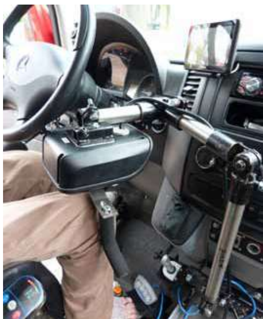
Links: aangepaste besturing en bediening. Rechts: lift om rolstoel in de auto te tillen.
